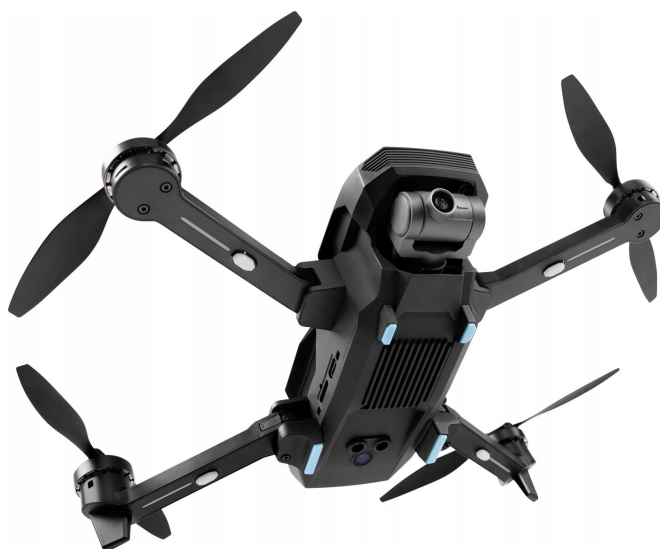
Rys. 2. Dron YUNEEC Mantis G zasilany silnikami elektrycznymi [11]
