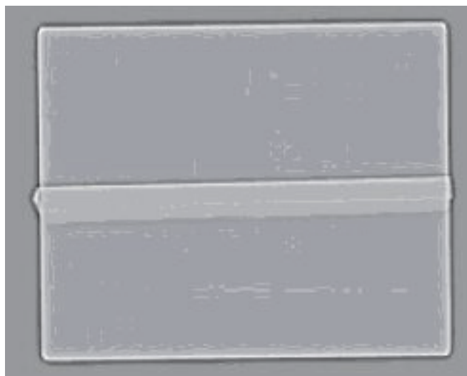
Rys. 11. Rekonstrukcja próbki nr 11 wykonana przy następujących parametrach: obraz warstw o grubości 0,6 mm, algorytm skanowania T80f Fig. 11. The reconstruction of the sample no. 11 made with the following parameters: image layers of thickness 0.6 mm, scanning algorithm T80f
