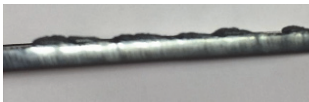
Rys. 10. Widok krawędzi po cięciu plazmą (fot. Z. Jarmoliński)
