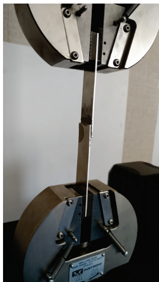
Rys. 2. Próbką zamocowana w uchwycie maszyny wytrzymałościowej
