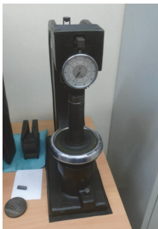
Rys. 2. Twardościomierz firmy Łucznik (fot. A. Piochacz) Fig. 2. A hardness meter produced by Łucznik (photo by A. Piochacz)
