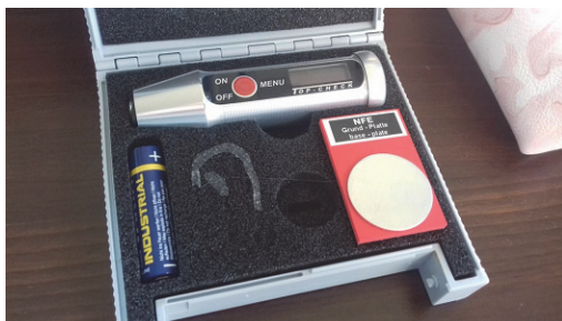
Rys. 1. Tester TOP CHECK do pomiaru grubości warstw anodowanych (fot. A. Piochacz) Fig. 1. A device TOP CHECK for measuring thickness of anodized layers (photo by A. Piochacz)
