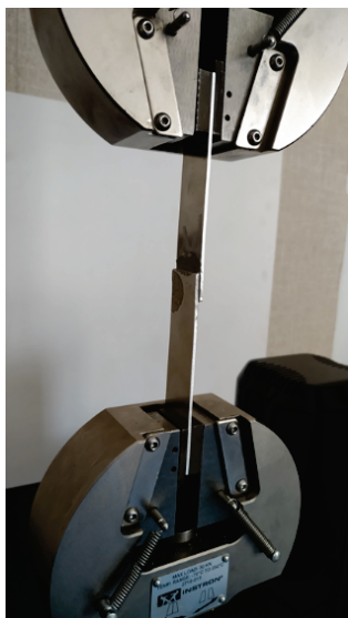
Rys. 2. Próbką zamocowana w uchwycie maszyny wytrzymałościowej
