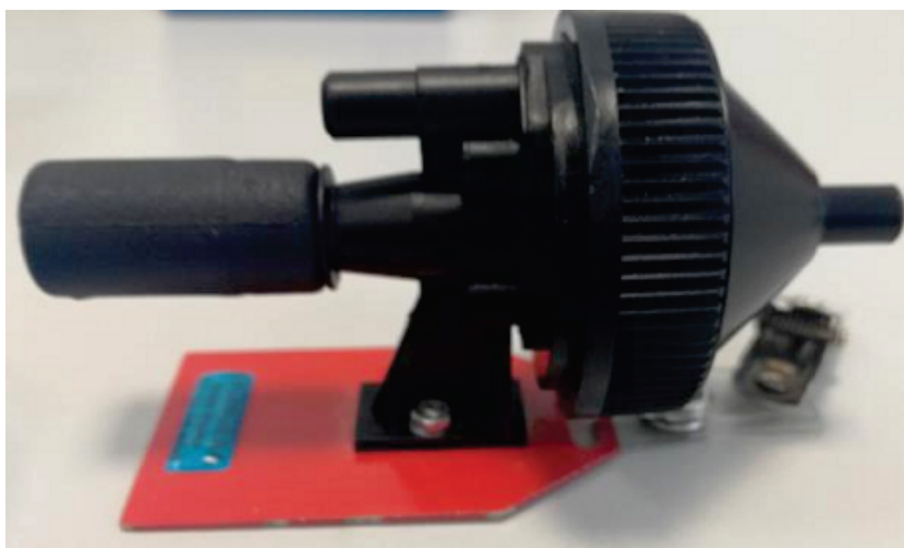
Fig. 6. Head for collecting respirable fraction (photo K. Pikulik) Rys. 6. Głowica do pobierania frakcji respirabilnej (fot. K. Pikulik)
