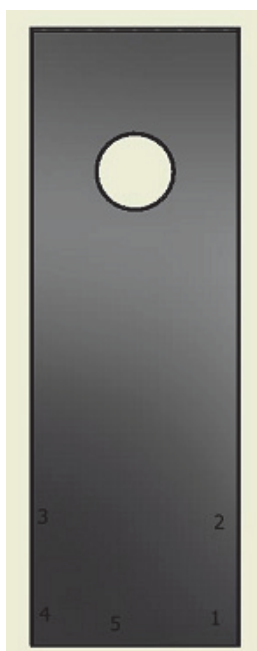
Rys. 14. Miejsca pomiarów twardości próbek bijaków dla danej odległości od krawędzi cięcia Fig. 14. Place for hardness measurements of flail samples for a given distance from the cutting edge
