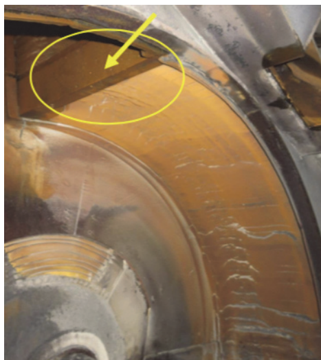
Rys. 4. Płaskownik progowy młyna MWk16 (opracowanie własne)
