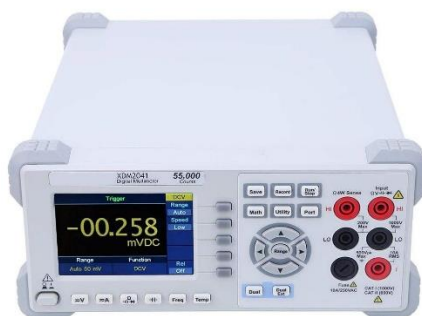
Rys. 10. Miernik XDM2041 OWON użyty podczas pomiarów kontrolnych urządzenia do jonoforezy [8]
