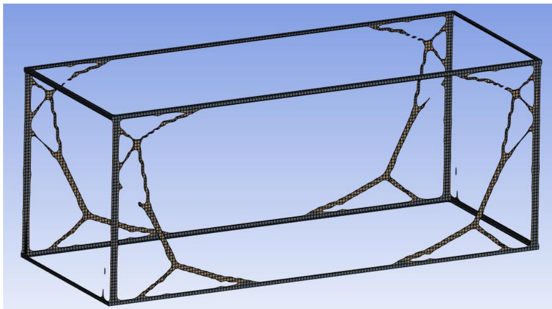
Rys. 7. Numeryczny model ramy zoptymalizowanej do 92,5% masy początkowej Fig. 7. Numerical model of the frame optimized to 92,5% of the initial weight
