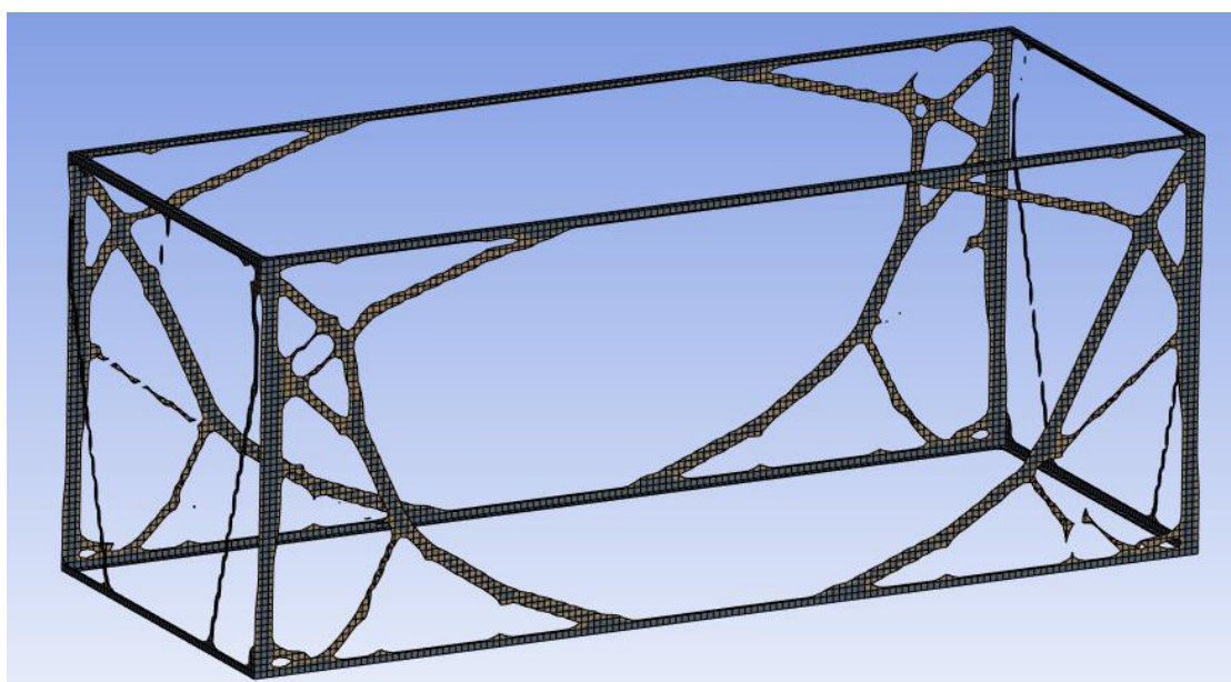
Rys. 6. Numeryczny model ramy zoptymalizowanej do 90% masy początkowej
