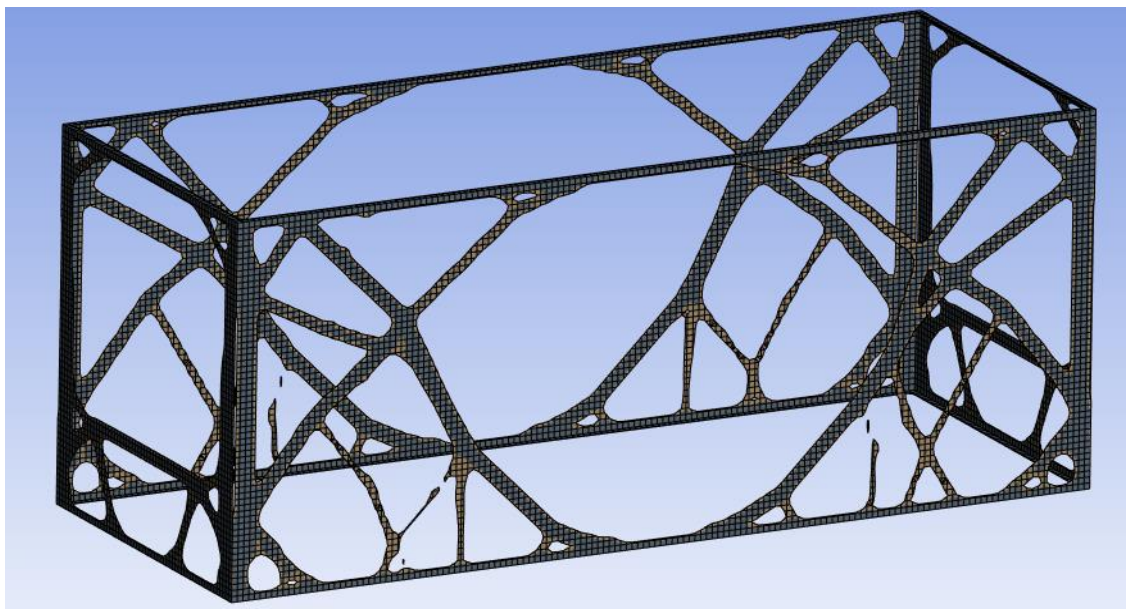
Rys. 5. Numeryczny model ramy zoptymalizowanej do 85% masy początkowej
